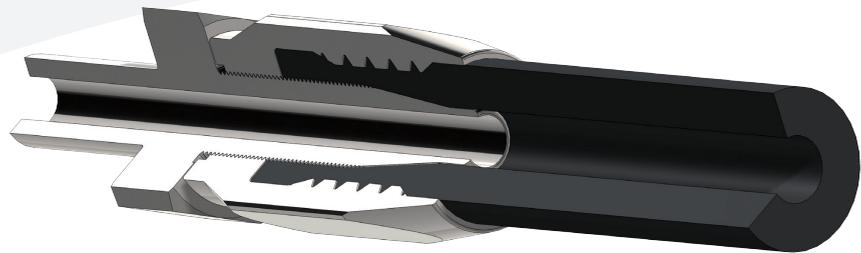
Par sertissage d'une douille sur les tresses métalliques de l'extrémité du boyau pour les hautes pressions.
